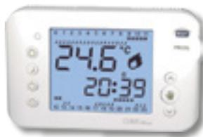
Cronotermostato da parete, con ampio display LCD retroilluminato, due livelli di temperatura impostabili: Comfort e Risparmio, programmazione minima 30 minuti, funzionamento Automatico/ Manuale, alimentazione a batterie 2 x 1,5V tipo AA.
