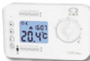
Cronotermostato da parete giornaliero, due livelli di temperatura impostabili: Comfort e Risparmio, programmazione tramite 24 microinterruttori orari funzionamento Automatico/ Manuale (termostato)/ OFF, display retroilluminato, alimentazione a batterie 2 x 1,5V tipo AA.
