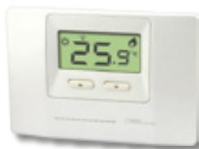
Termostato da parete, due livelli di temperatura impostabili: Comfort e Risparmio, possibilità impostazione limite superiore e inferiore di temperatura, ingresso per il collegamento di una sonda esterna, alimentazione a batterie 2 x 1,5V tipo AAA.
