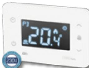
Cronotermostato settimanale da parete con comunicazione WiFi per la gestione tramite smartphone con un APP dedicata, fino a 6 livelli di temperatura impostabili, funzionamento Automatico/ Manuale, ampio display LCD retroilluminato, sicurezza blocco tastiera, alimentazione 230 V.
